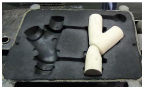
maximale Materialersparnis durch formgenaue Sandkerne
