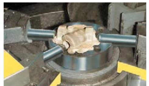
Minimierung des Einsatzgewichtes durch das Hohlpressverfahren
