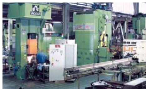
Wirtschaftlichkeit durch den Einsatz moderner Gesenkschmiedeautomaten
